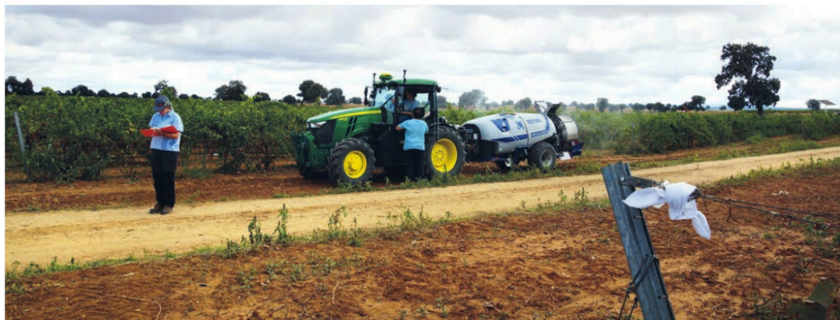
Prueba de campo realizada en la finca El Socorro del Imidra para obtener la información que se visualiza en el terminal del sistema Smart Apply, comparándola con los registros manuales de volumen de vegetación.
