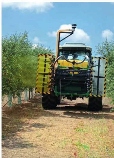
Foto 7. Equipo electrostático aplicando producto por su sector izquierdo.
