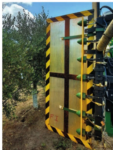
Foto 3. Boquillas electrostáticas con electrodo trabajando a tensión de 1 kV.
